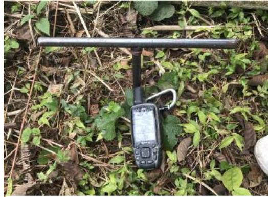
圖四 現場量測土壤深度之情形
