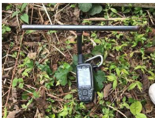
圖四 現場量測土壤深度之情形
