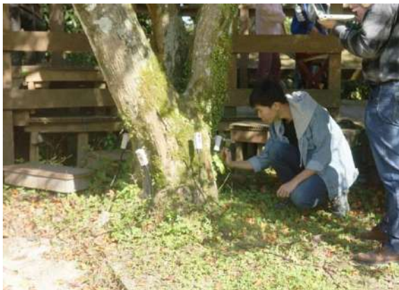
圖一 受保護樹木普查工作—以非破壞性原理-應力波診斷檢測樹木健康情形
