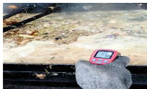
圖十五 紅外線測溫槍偵測廚餘蒸煮情形
